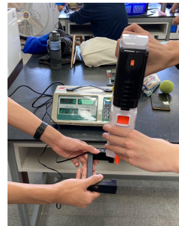
(圖四)光電計時器測Nurf 槍子彈速率
