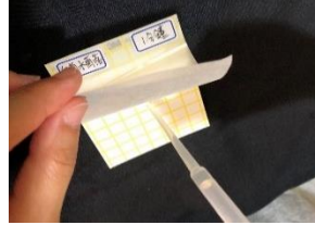
⑧使用 3M Petrifilm 總生菌數快檢片(48 小時測試)
