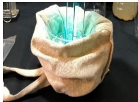
⑦紫消燈入水測試，外部用提袋隔絕以保護眼睛。
