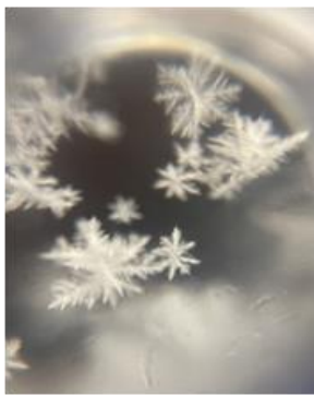
圖 1 10°C結晶形狀為冰晶狀
