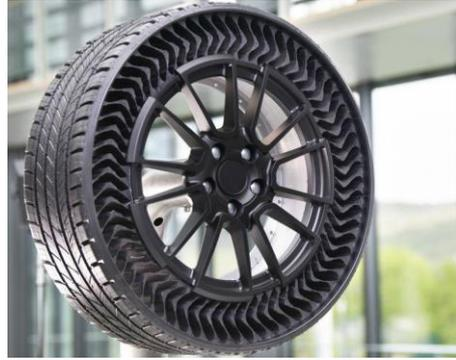
目前免充氣輪胎有許多不同的材料，因此我就以 Michelin 的輪胎作介紹，Michelin 輪胎的材料主要是天然橡膠，當然裡面還有許多成分，包括合成橡膠、金屬、纖維，GFRP.....等，其中 GFRP 就是所謂的玻璃鋼，這個材料的性質是它比傳統材料還要輕，可以減輕車子的重量，減少燃油消耗，還有良好的耐腐蝕能力，可以增加輪胎的壽命，還有良好的彈性，可以用來適應不同的路面，而且最主要的是可以增加行駛中的平穩性及舒適度，剛好克服木頭輪胎的缺點，最後還有抗疲勞的性能，可以使輪胎承受連續高強度的使用。當然除了材料方面的進步以外，還有輪胎結構的不同，免充氣輪胎的結構主要要克服的就是支撐力以及增加舒適度，其中網狀結構的設計就有解決問題，因為網狀結構可以將重量分布均勻，增加支撐力及提高穩定性，網狀結構中的空隙也可以緩衝路面的顛頗，提高駕駛的舒適度。
