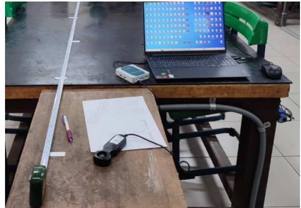
圖九 使用 VERNIER 威尼爾儀器風速計測量風速
