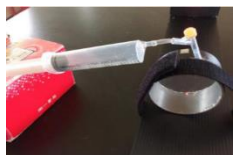
圖 2-用注射針筒調整透鏡凹凸
