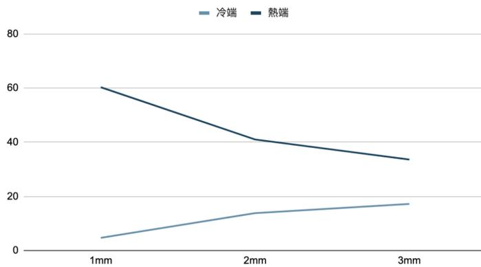
實驗完我們發現開孔大小也會影響氣體溫度, 孔洞越大溫度的變化越不明顯, 比較接近常溫。
