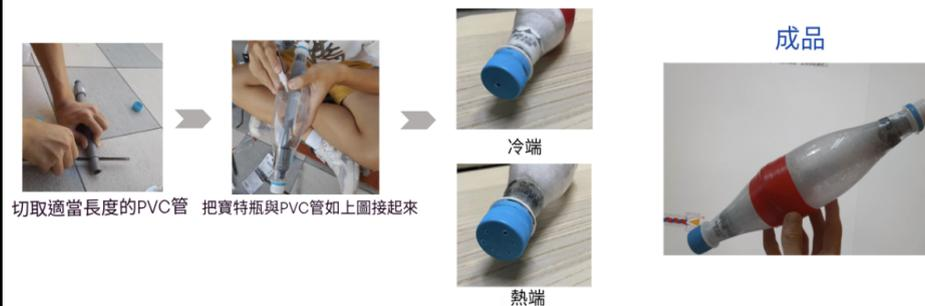
我們利用壓縮空氣注入渦流管內以產生足夠的壓力，這壓力必須要能使氣體分子在入氣孔加速到音速，使氣體能在管內旋轉並產生渦流。進入瓶內後，因為氣流的角速度不同，氣流產生摩擦並把能量傳遞到外層。中間的氣體因為能量與速度降低，從另一端的孔洞流出，達到冷熱空氣分離的效果。
