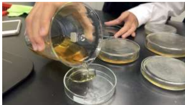
將培養基倒入培養皿
