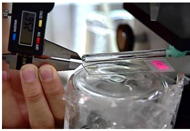
圖 5 自製複式顯微鏡牽絲距離測量
