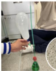
1. 玻璃管、橡皮管沾水
