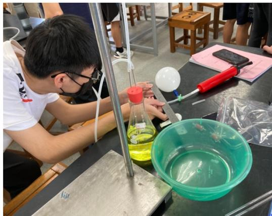
▲ 透過水柱的高度，量測氣球內外的壓力差，並計氣球的大小
