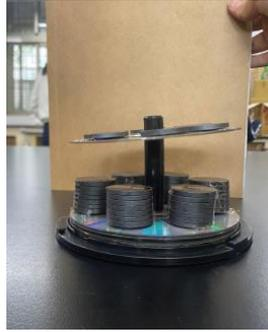
圖二：磁鐵陣列與光碟片重量平衡實驗。
