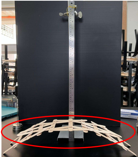
圖四、 左圖為本次實驗裝置，由紅色線圈起的正是本次實驗對象:達文西橋 (圖片來源:本組自行拍攝、繪製)
