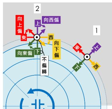
圖七 赤道地區位移向量隨時間與方向標發生偏移
