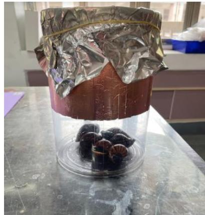
**結果：**對固定寬度金屬片穿越能力實驗中，銅片及銅箔的圍欄仍有蝸牛可以穿越，而鋅片及鐵片在第一小時後就全數穿越。銅網及氧化銅網都沒有蝸牛穿越。
