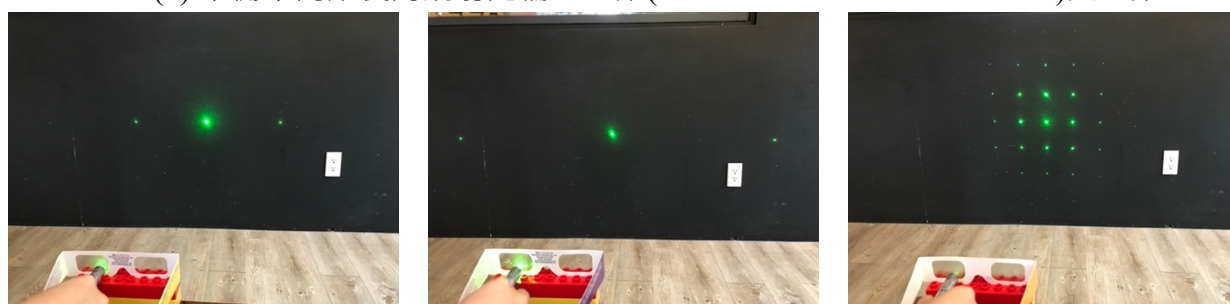
圖 14 繞射光柵 500 lines/mm 圖 15 繞射光柵 1000 lines/mm 圖 16 二維繞射光柵
