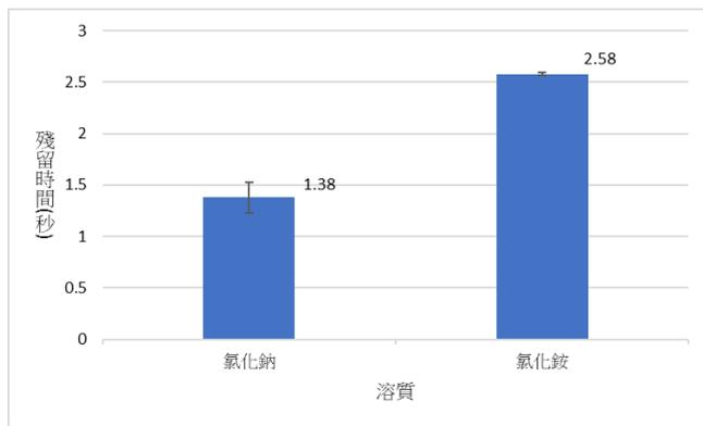
由圖表可得知，氯化銨( $\text{NH}_4\text{Cl}$ )的磁場殘留時間將近是氯化鈉( $\text{NaCl}$ )的兩倍，兩者之間的差異非常大。
