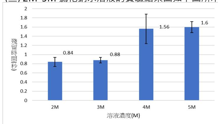
由圖表可得知，當溶液濃度在 2M 和 3M 時，磁場殘留時間均不及 1 秒，大約在 0.8 秒左右，沒有太大的起伏，但是當濃度達 4M 時，磁場殘留時間突然攀升至 1.6 秒左右，磁場殘留時間相較於 2M 和 3M 的 0.8 秒相差甚遠。
