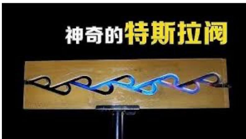
圖 1 特斯拉閥構造
