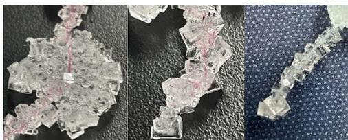
圖十二 棉繩作為附著物養晶之正方體結晶
