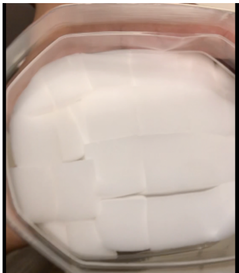
圖二 海綿切開至於寶特瓶內，模擬岩曾在地下的狀況
