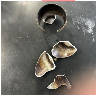
(圖 6、高火功率微波—容器破裂現象)
